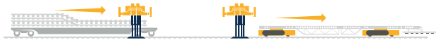
Podniesione bramownice – kratownica z wózkami wyjeżdża spod nich, a wjeżdża wagon z rozjazdem / Raised gantries – truss with trolleys departs from underneath, replaced by a wagon with a turnout
